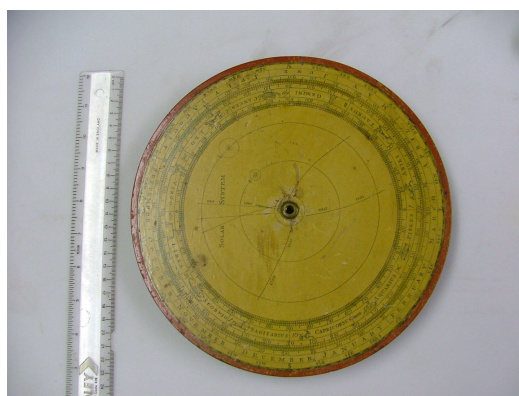
圖 5：AST1061 的底盤。讀者可留意在底盤上印有三組彗星軌道。
